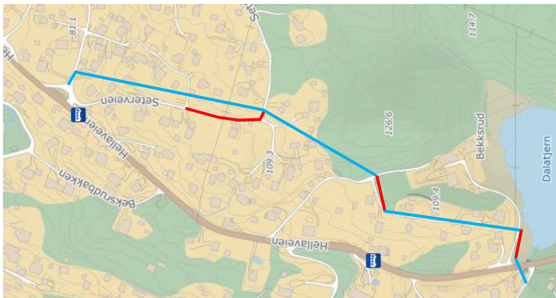
Figur 1: Figuren viser traséen for vann- og avløpsledningene. Blå linje viser boretrasé, og rød linje viser gravetrasé.
